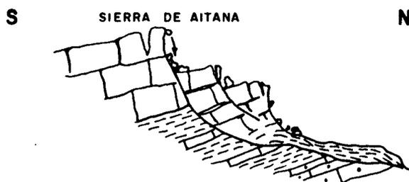
Figura 6. Corte esquemático, sin escala, del movimiento de la Sierra de Aitana
